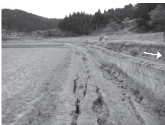
写真8 側方流動の痕跡
